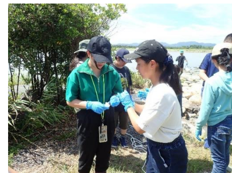
注射器の先端にフィルターを取り付けて、魚の DNA が含まれる海水を漉していきます。
