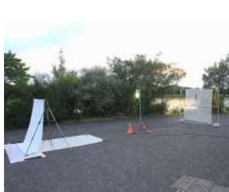
これがライトトラップの装置。強力な水銀灯で昆虫を集めます。
